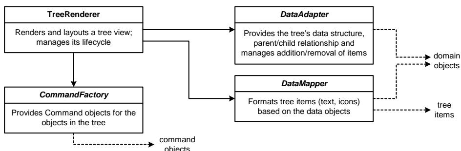
Ein *DataAdapter* bildet die hierarchische Datenstruktur auf die Anforderungen des Treeframeworks ab und kümmert sich um das Anlegen/Verschieben/Löschen von Kindern (Adapter Pattern). Der *DataMapper* definiert das Aussehen von Baumknoten für bestimmte Datenelemente (z.B. Text, Icon). Die *CommandFactory* definiert die Kontextmenüs für die verschiedenen Baumelemente. Der *TreeRenderer* ist eine Frameworkklasse und ist für die Darstellung des Baumes zuständig.
